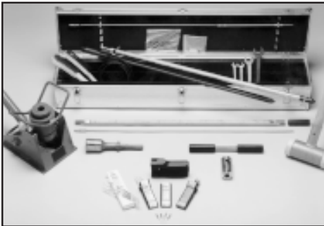
Bodenluftsonde mit Zubehör, Dräger-Röhrchen, Gasspürpumpe accuro
