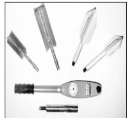
Scherfestigkeitsmesser gemäß DIN 4096
