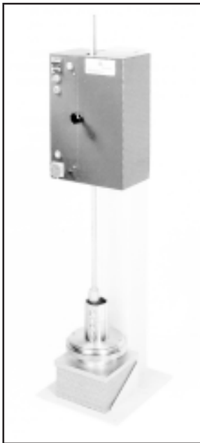
automatischer Proctor nach DIN 18 127
