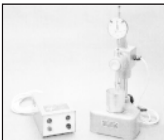
Konuspenetrometer mit elektrischer Fallstab- führung
