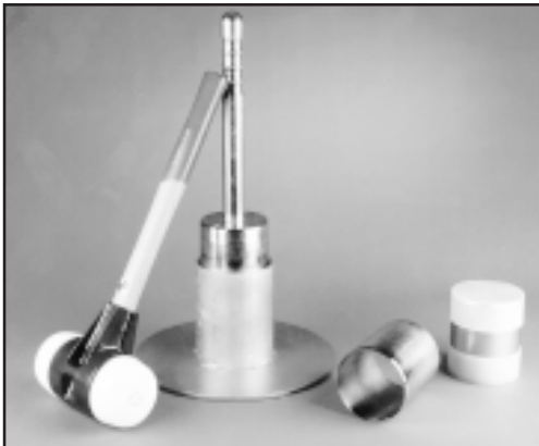
Ausstechzylinder mit Schlaghaube, Bodenplatte und Hammer
