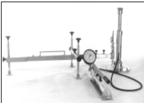
Einuhrplattendruckgerät (mit direkter Messung)
