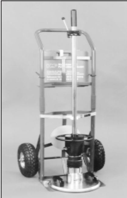
Fallgewichtsgerät mit Transportwagen und Magnetplatte
