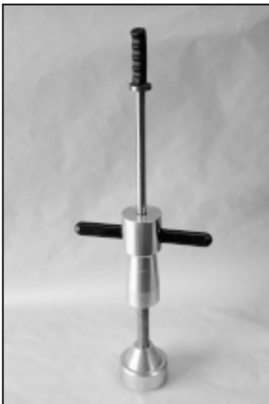
Eintreibvorrichtung gemäß DIN 4021
