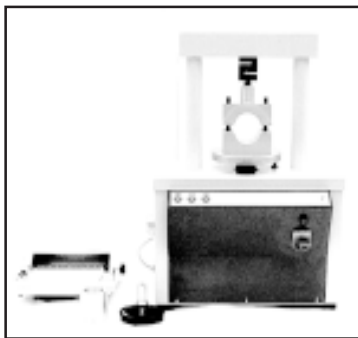
Marshall-Druckprüf- maschine 50 kN mit Schreiber
